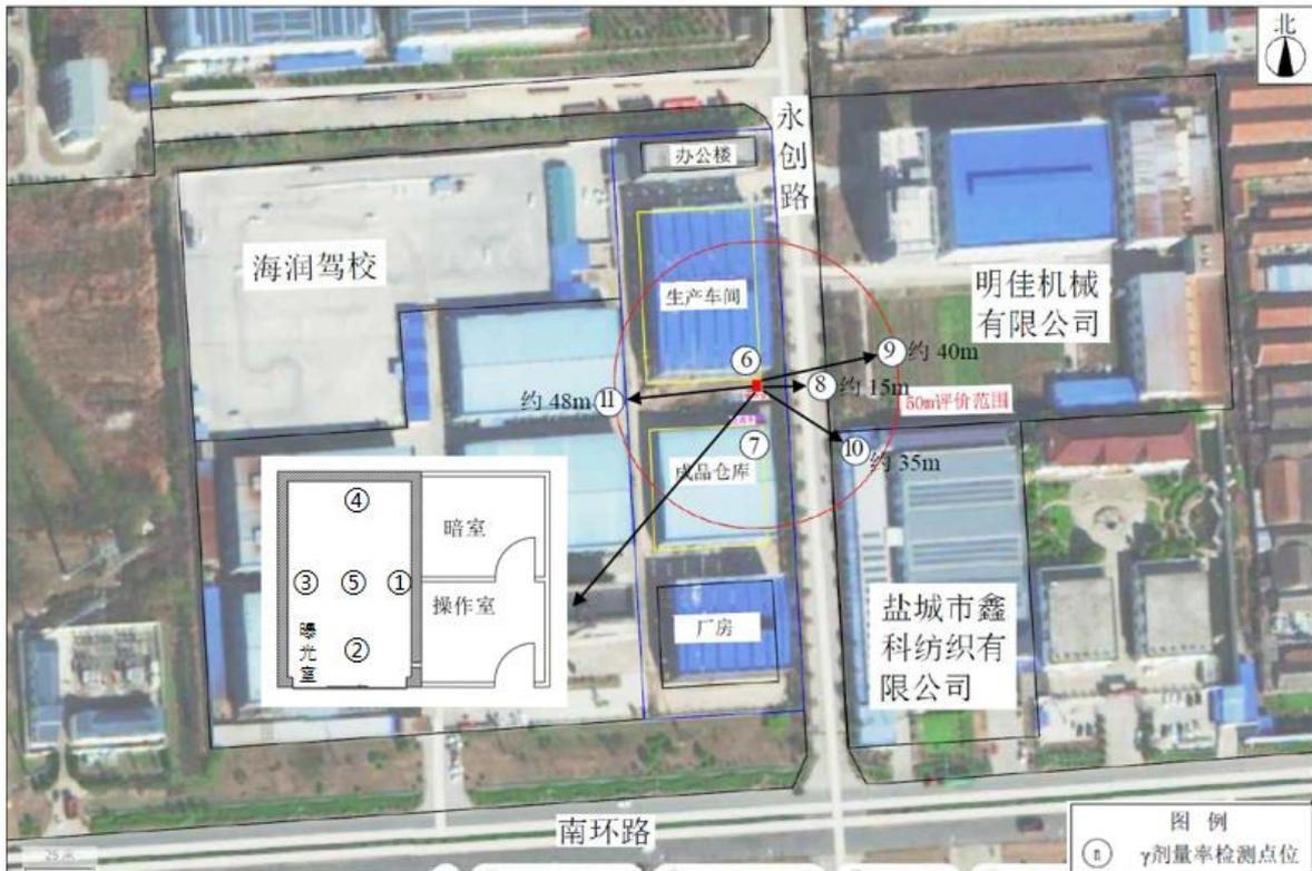
图8-2 铅房拟建址周围辐射环境检测点位示意图
