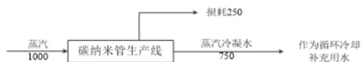
图 3.3.4-2 年产 3000 吨碳基纳米材料项目（一期 900 吨）蒸汽平衡图 (t/a)
