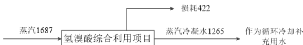
图 4.1.6-1 本项目蒸汽平衡图 (t/a)
