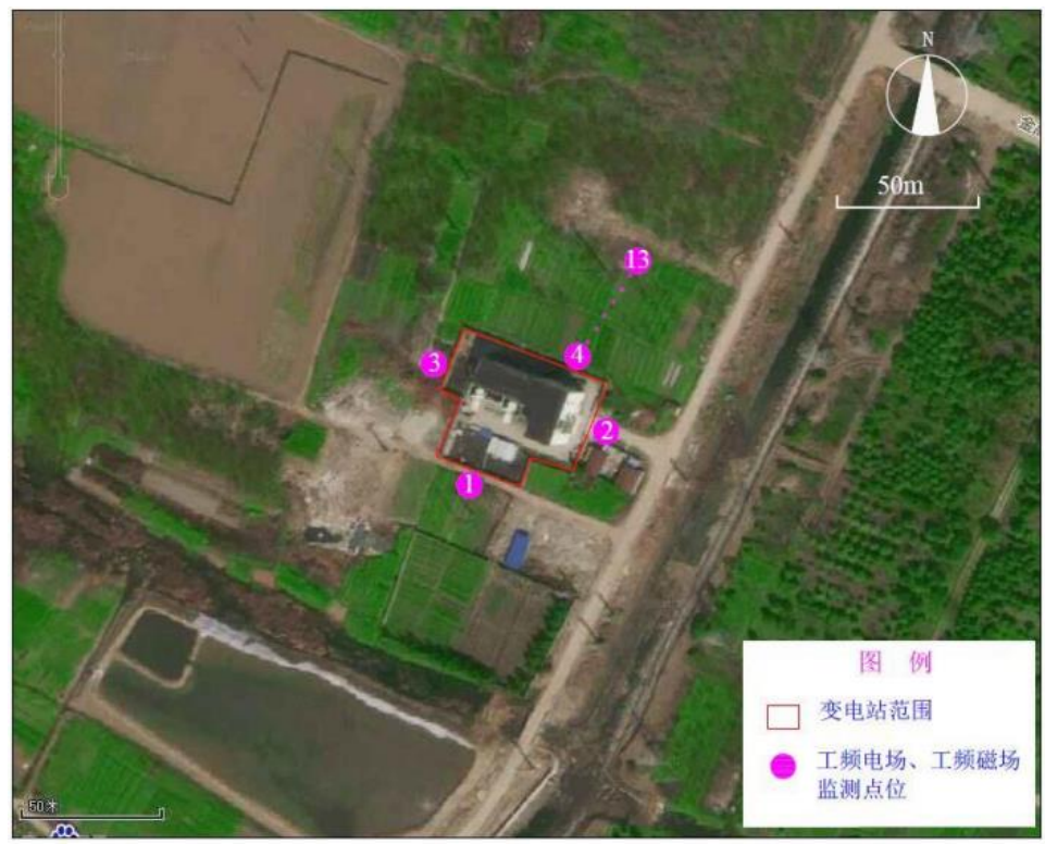
图 3.2-2 苏州 110kV 吴市变电站监测布点图
