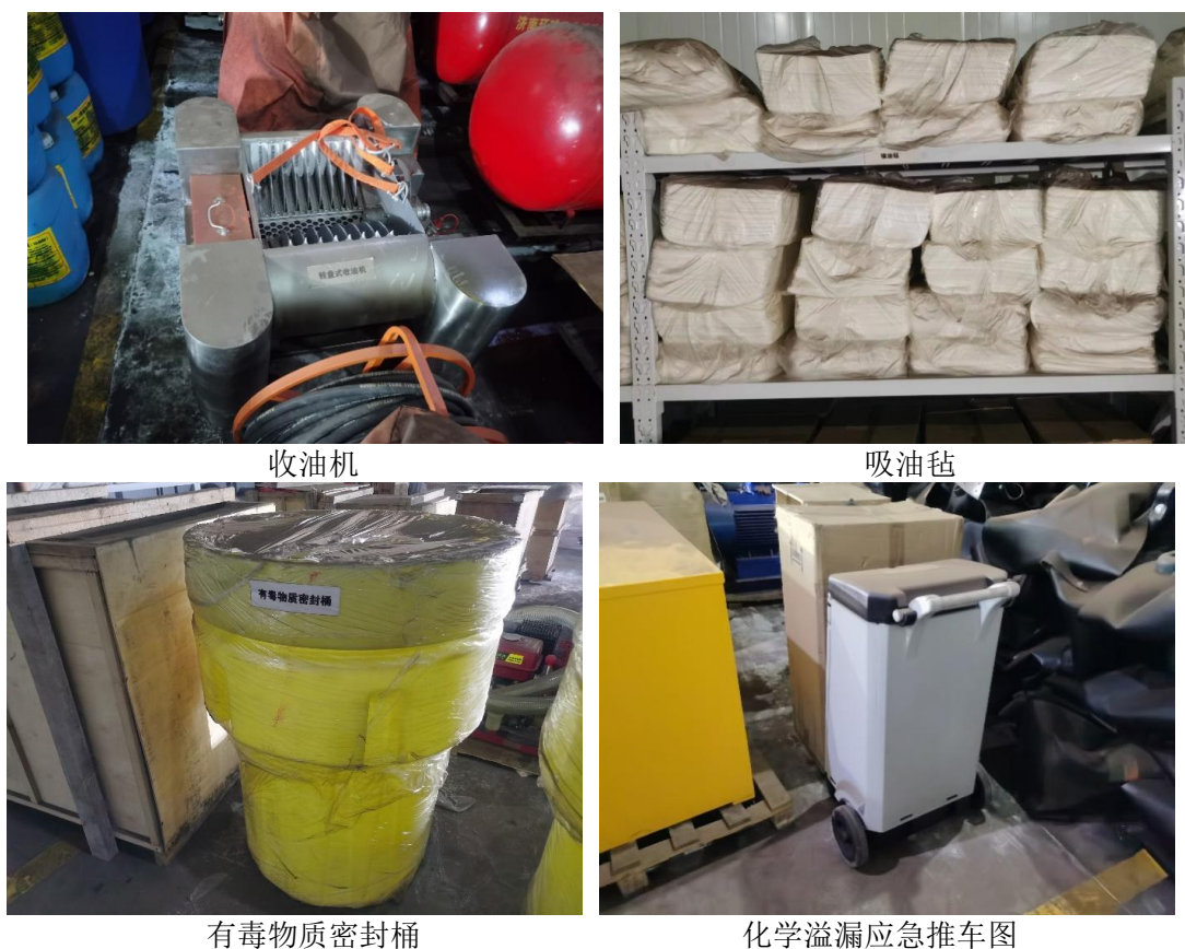
图 7.8-7b 已配备的船舶防污染设备设施照片
