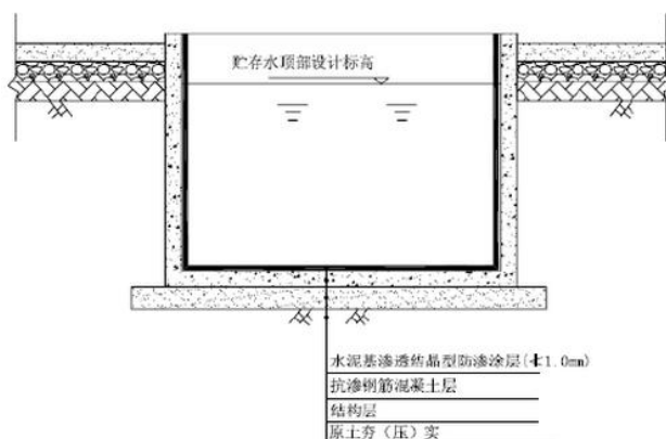
图 6.6-5 污水调节池防渗层示意图
