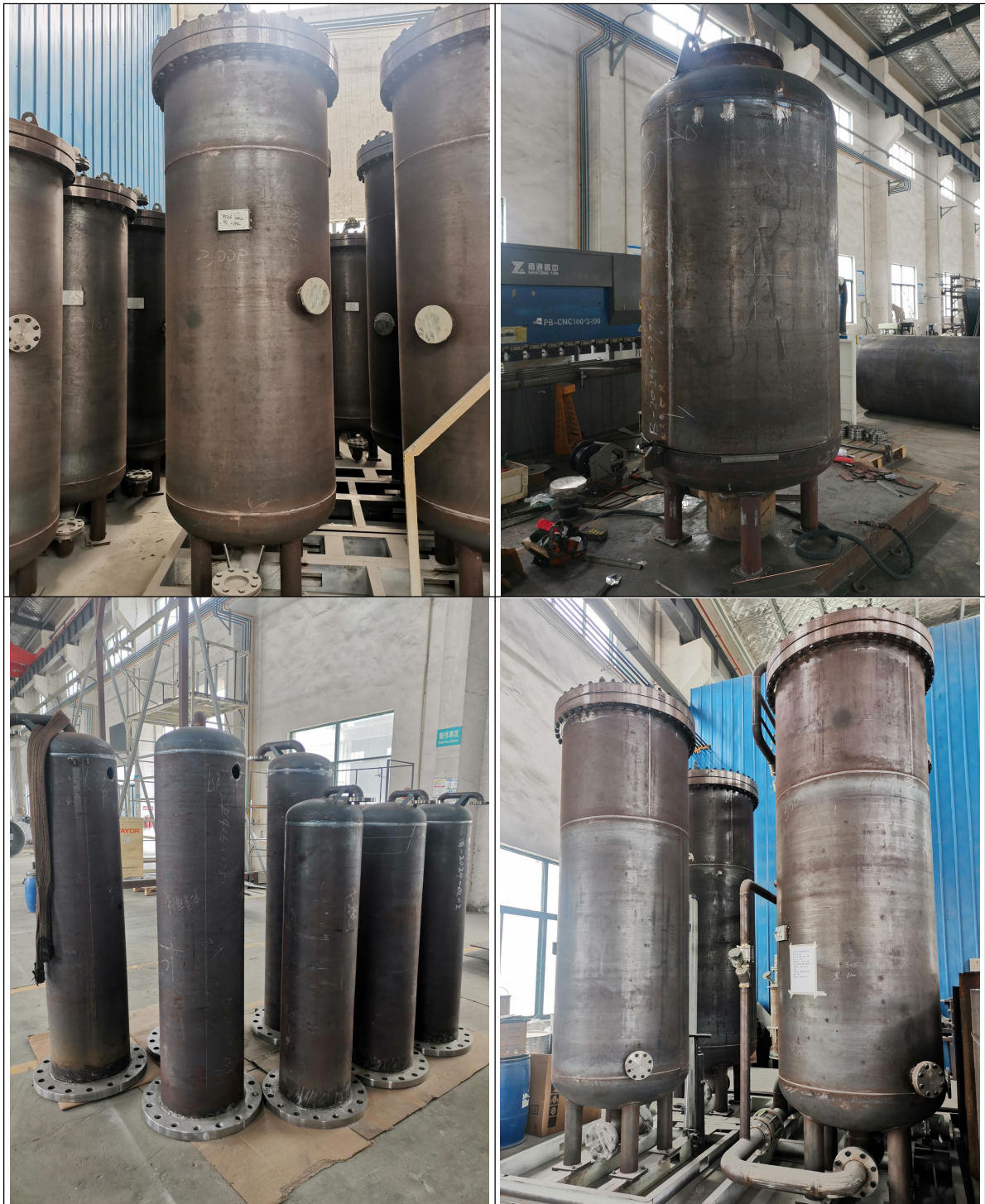
图 9-5 本项目探伤房主要探伤工件示意图
