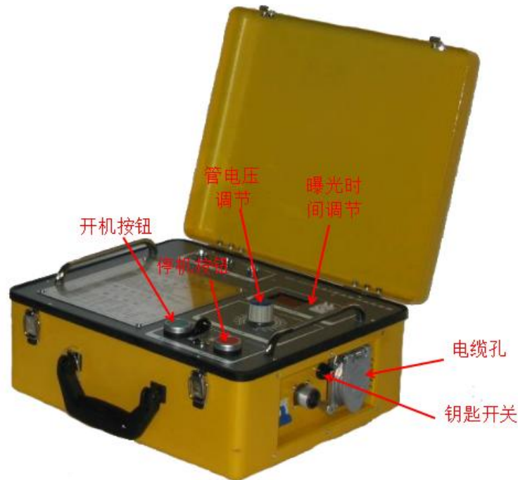
图9-2 常见X射线探伤装置控制台
