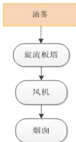
图 7.1-2 二级油雾洗涤塔系统流程图
