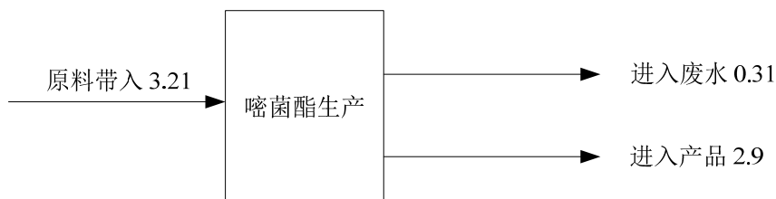
图 4.2.2-4 嘧菌酯铜平衡图
