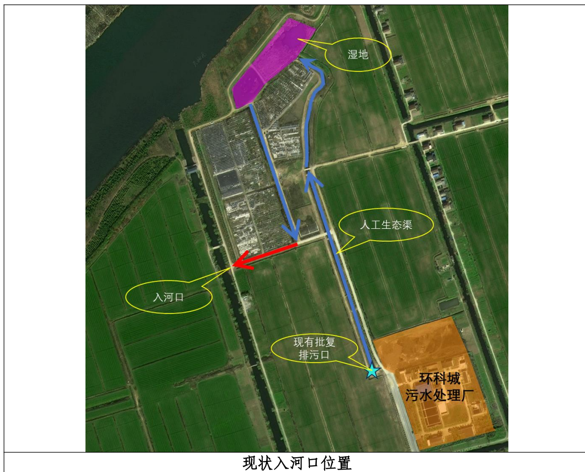
图 3.3-5 现状污水厂人工河道及人工湿地
