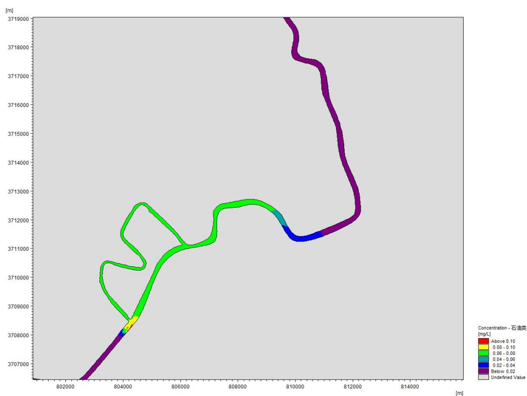
图 6.1-20 事故排放工况石油类增量浓度影响范围结果图
